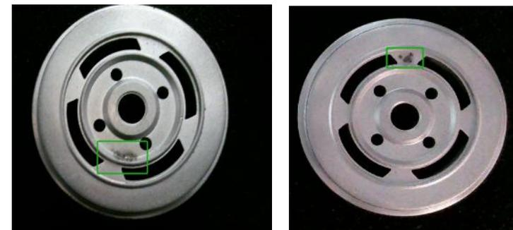
零件表面瑕疵质量检测
